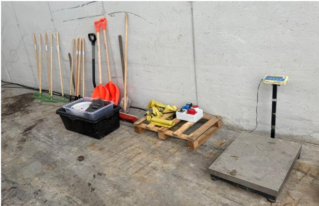
Zdjęcie 3.3.2. Widok mobilnego stanowiska do przeprowadzenia analizy „czarnego worka”
